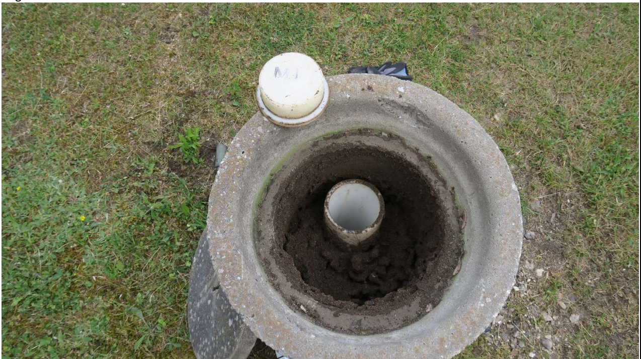
Foto 2: Boring DGU. Nr. 81.292 (M1) er udført i Ø125 filterrør, placeret i et Ø300 mufferrør, med betonglåg og låsestang (uden lås).
