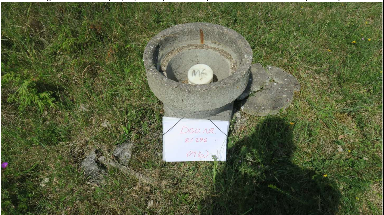
Foto 14: Boring DGU. Nr. 81.296 (M6) er udført i Ø125 filterrør, placeret i et Ø300 mufferrør, med betonlåg og låsestang.
