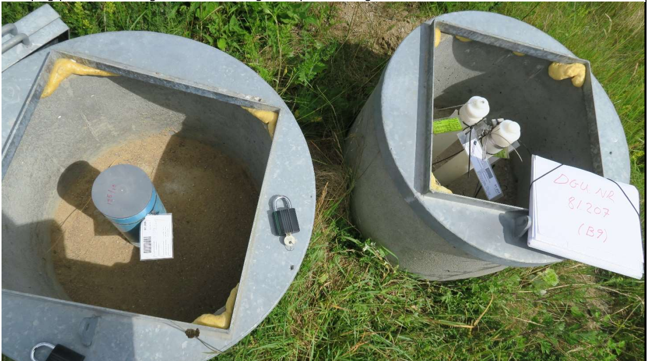
Foto 34: Boring DGU Nr. 81.207 (B9) og boring DGU Nr. 81.208 (B9) har 3 indtag, placeret i 2 stk. Ø600 betonrør med støbt bund og 50 cm firkantet galvaniseret låg. BEMÆRK DGU NR. FOR INDTAG 1 er 81.208. DGU nr. for indtag 2 og indtag 3 er 81.207 (B9). Indtag 1 er Ø125, Indtag 2 og 3 er Ø63.
