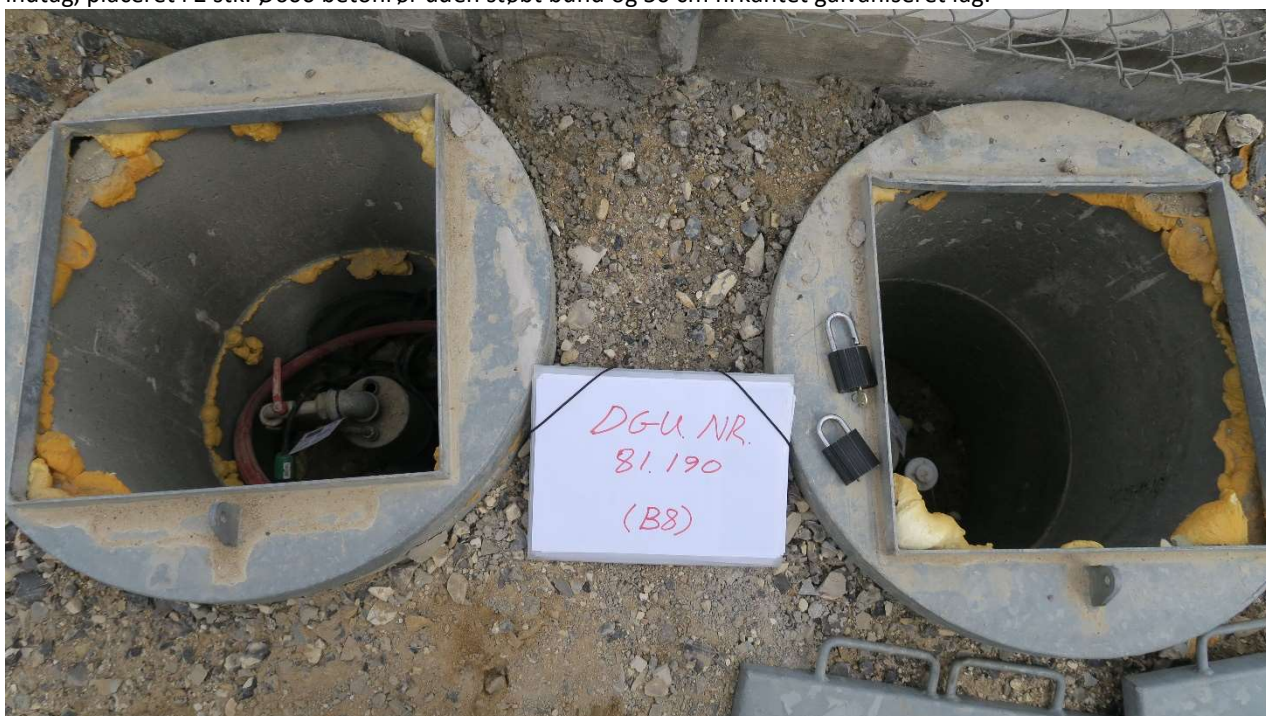
Foto 32: Boring DGU. Nr. 81.190 (B8). Indtag 1 er Ø125 med taphane og fast pumpe med 240 V stik monteret. Indtag 2 er Ø125 og indtag 3 er Ø63.
