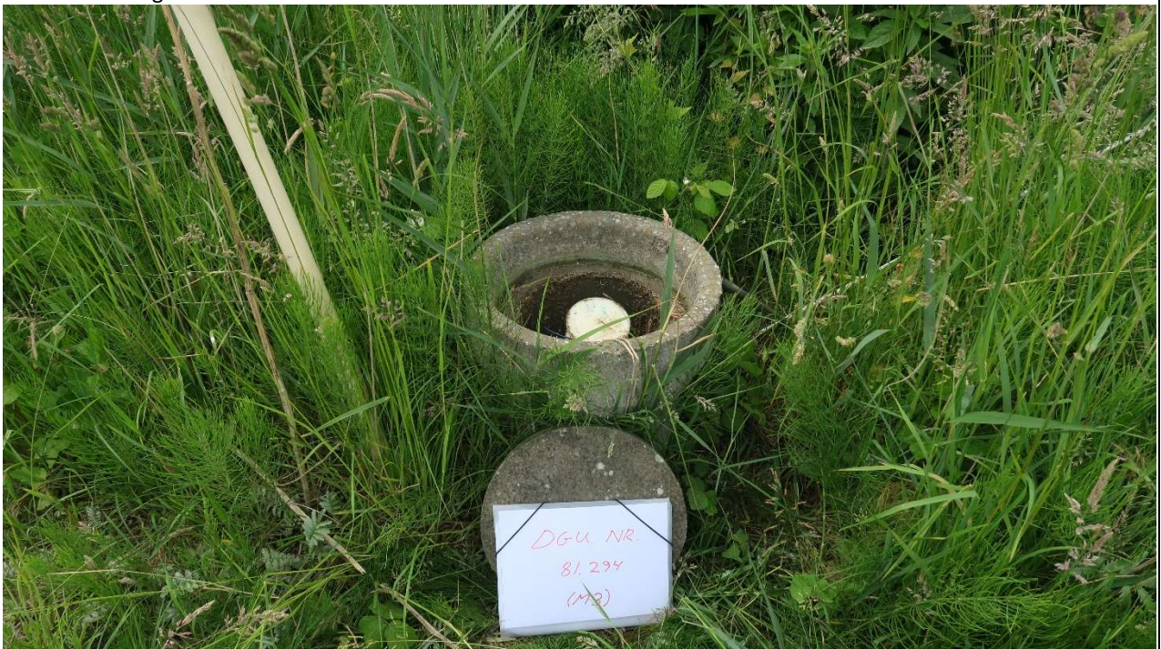
Foto 6: Boring DGU. Nr. 81.294 (M3) er udført i Ø125 filterrør, placeret i et Ø300 mufferrør, med betonlåg og låsestang.
